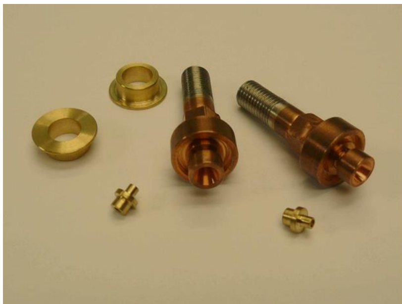
Рис. 13.20 – Фотографии сконструированных и произведенных съемных сопловых насадок с улучшенным профилем внутренней части
