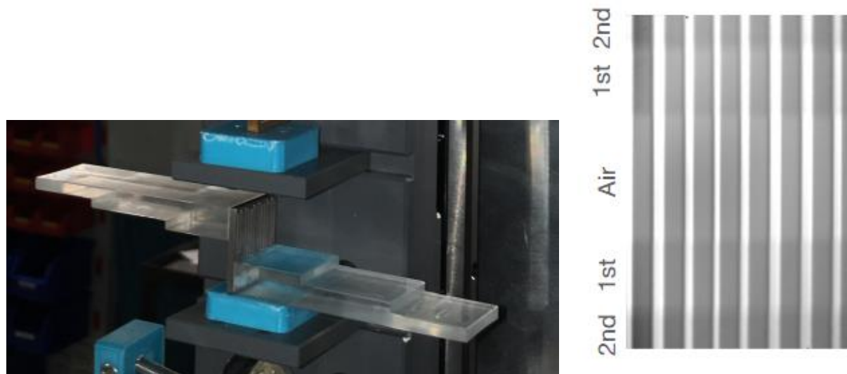
Рис. 10.2 – Слева фотография мишени (толщина танталовой пластины 1.5 мм) служащей для оценки влияния хроматических aberrаций ионной оптики протонного микроскопа установки на получаемые изображения; справа – протонно-радиографическое изображение мишени при энергии протонов 4.0 ГэВ
