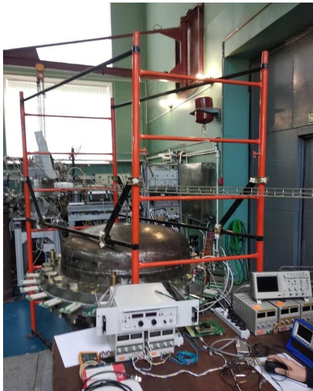
Рис. 17.4 – Станция трекера, расположенная в корпусе детектора для проведения тестов в реальных условиях (20 атм рабочей газовой смеси)
