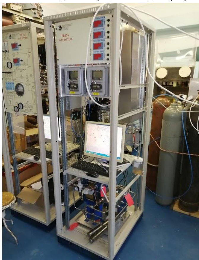
Рис. 17.7 – Газовая система, смонтированная в стойке
