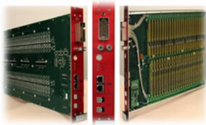
Рис. 12.3– Модуль DB50 высоковольтной системы HVDS на 50 каналов
