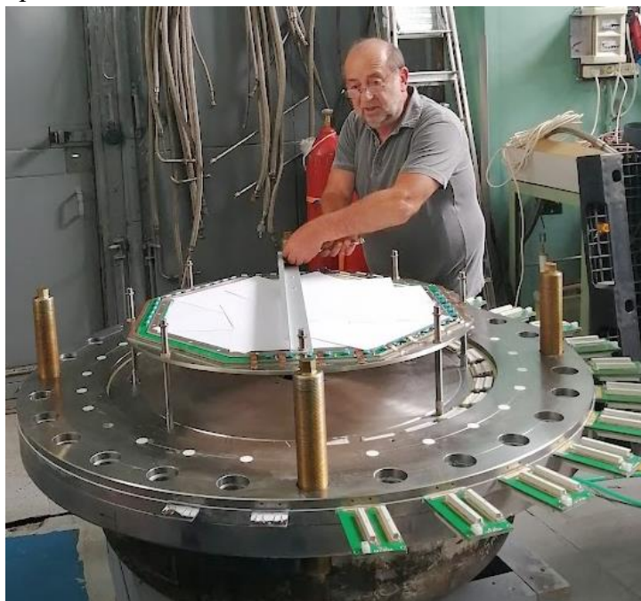
Рис. 18.4 – Способ размещения станции переднего трекера на несущем фланце
