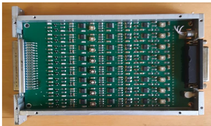
Рис. 13.17 - Внешний вид одного модуля 16 канального усилителя для АСТАФ2
