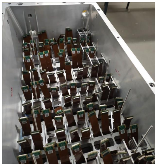
Рис. 14.11 - Гибкие печатные платы и адаптеры внутри балки
