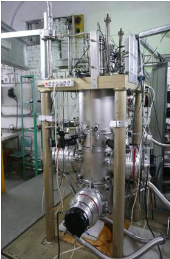
Рис. 14.18 – Фотография прототипа криогенной корпускулярной мишени Pellet Target
