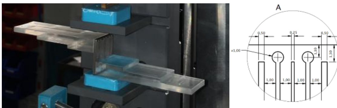
Рис. 11.12 – Слева – мишени на столике, прорези решетки вертикальны; справа – фрагмент чертежа прорезей в решетке из тантала.
