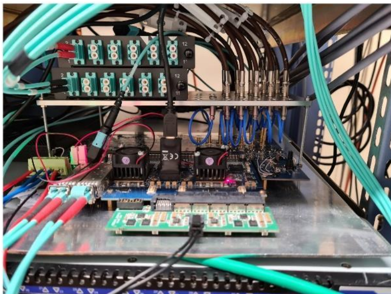
Рис. 12.21 - Плата ADC64 с интерфейсным блоком подключена к системе сбора данных эксперимента mCBM, июнь 2021. Сверху в патч панель ведут коричневые коаксиальные сигнальные кабели длиной 60м, другим концом подключенные к плате FEE
