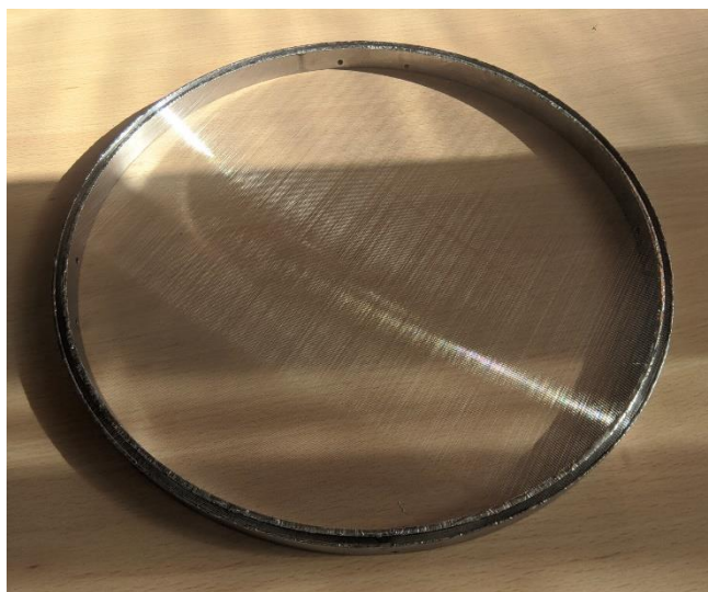
Рис. 13.16 – Внутренний элемент (сетка) активной мишени АСТАФ2
