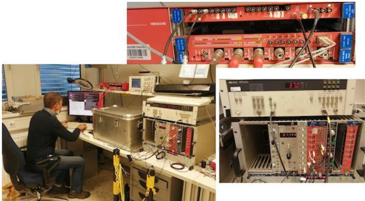
Рис. 5.5 – Общий вид прототипа тестового стенда для измерения световыхода сцинтилляционных тайлов и основное измерительное оборудование
