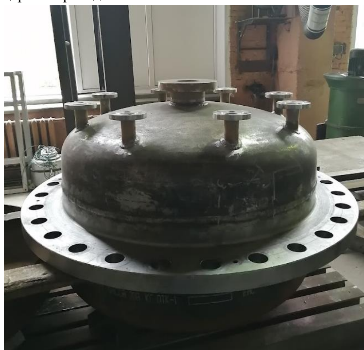
Рис. 18.9 – Крышка газового объема с приваренными штуцерами
