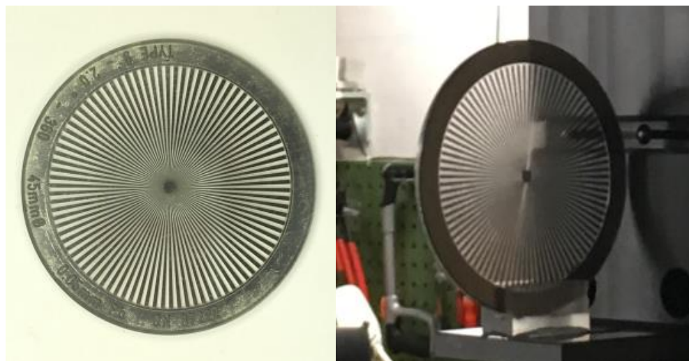
Рис. 11.14 – Диск из свинца с концентрическими прорезями, наклеен на диск из прозрачного пластика
