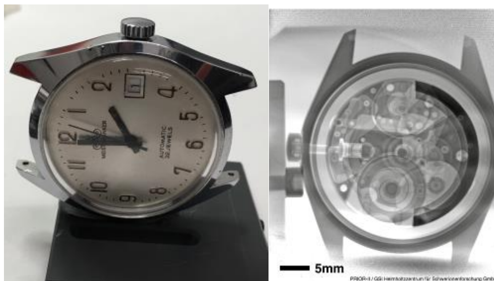
Рис. 11.15 – Механические часы и их радиографическое изображение
