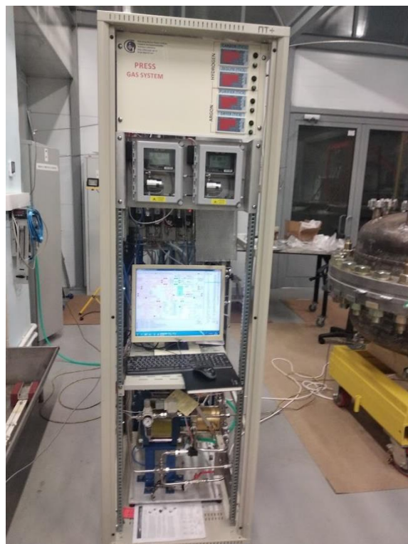
Рис. 18.8 – Главная стойка газовой системы, подготовленная для проведения тестового сеанса
