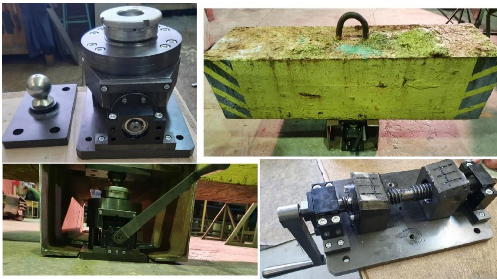
Рис. 12.40 - Прототип верхней части регулируемой опоры (слева сверху) под нагрузкой (справа сверху и слева внизу) и во время проверки (справа внизу)
