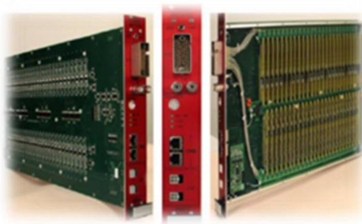
Рис. 13.7– Модуль DB50 высоковольтной системы HVDS на 50 каналов
