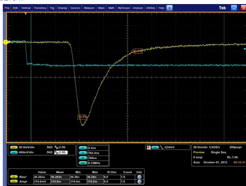
Рис. 12.14 – Осциллограмма стандартного сигнала фотоумножителя калориметрической ячейки
