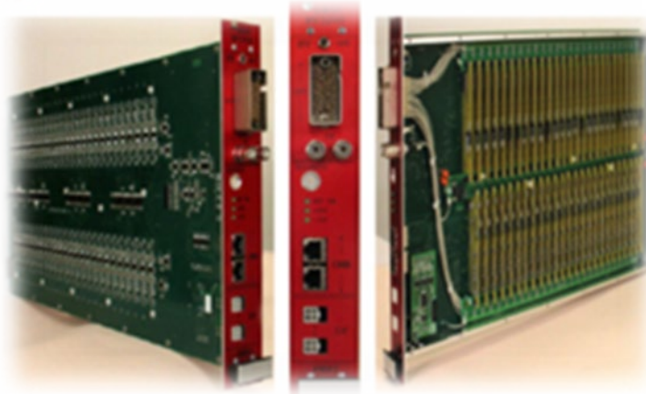
Рис. 13.4– Модуль DB50 высоковольтной системы HVDS на 50 каналов
