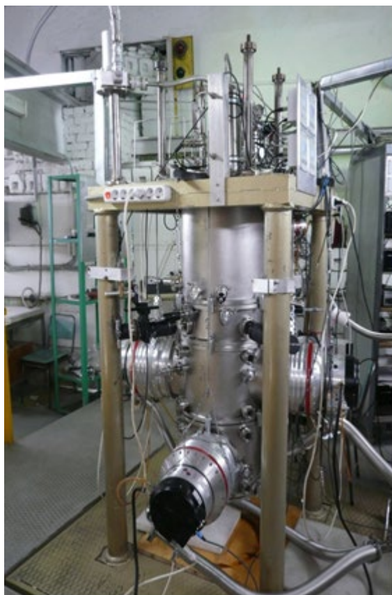
Рис. 14.10 – Фотография прототипа криогенной корпускулярной мишени Pellet Target
