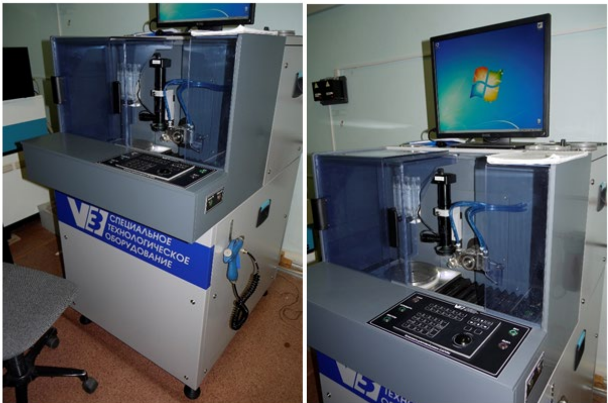
Рис. 12.8 – Установленная на производственной площадке фирмы С-Компонент гравировально-фрезерная установка
