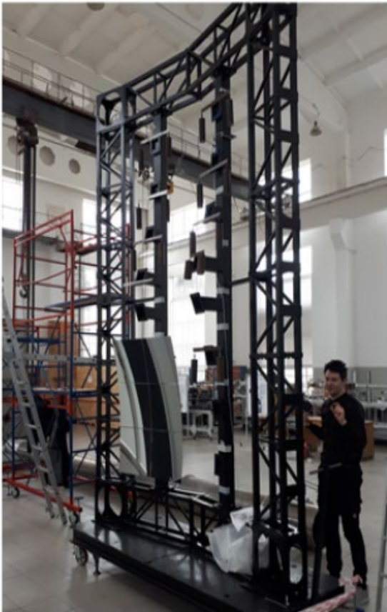
Рис. 12.53 – Полноразмерный прототип фермы для поддержки зеркал с установленными тестовыми зеркальными плитками (три небольшие рамы с шестью зеркальной плитки) (слева), установлена зеркальная плитка, вид сзади, небольшие рамы и опоры (вверху справа), шесть световых пятен отраженного света из зеркальных плиток теста расфокусированный лазер (внизу справа)
