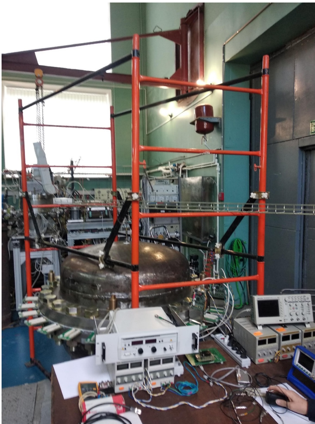
Рис. 18.4 – Станция трекера, расположенная в корпусе детектора для проведения тестов в реальных условиях (20 атм рабочей газовой смеси)
