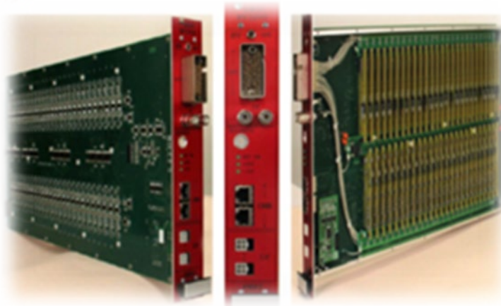
Рис. 13.4– Модуль DB50 высоковольтной системы HVDS на 50 каналов
