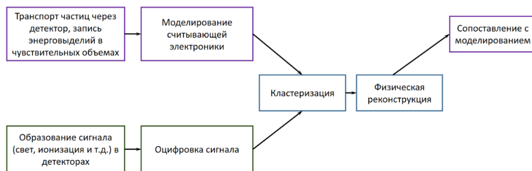
Рис. 12.13 – Схема моделирования, получения и обработки информации в калориметре СВМ
