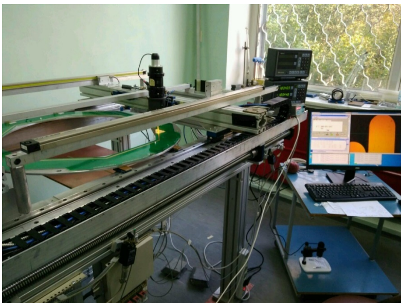
Рис. 18.5 – Установка для измерения положения проволочек трекера
