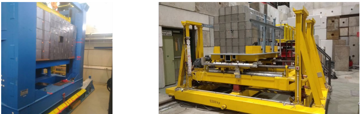
Рис. 12.27 – Слева новый передний калориметр установки BM@N. 20 модулей калориметра CBM использованы в его внешней части; справа модернизированный калориметр установки NA61; 13 модулей калориметра CBM использованы для внутренней области и верхней частей калориметра (выделяются более светлым цветом)
