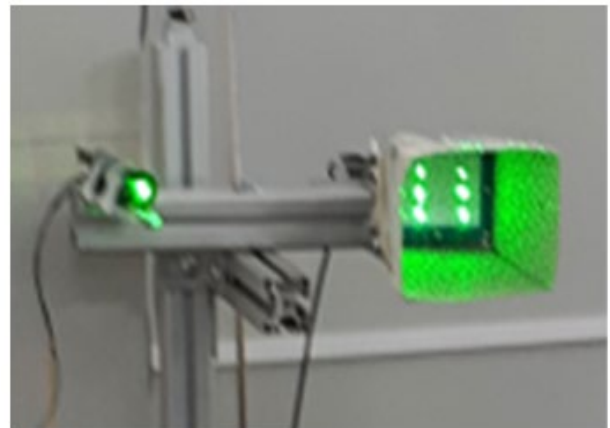
Рис. 12.53 – Полноразмерный прототип фермы для поддержки зеркал с установленными тестовыми зеркальными плитками (три небольшие рамы с шестью зеркальной плитки) (слева), установлена зеркальная плитка, вид сзади, небольшие рамы и опоры (вверху справа), шесть световых пятен отраженного света из зеркальных плиток теста расфокусированный лазер (внизу справа)
