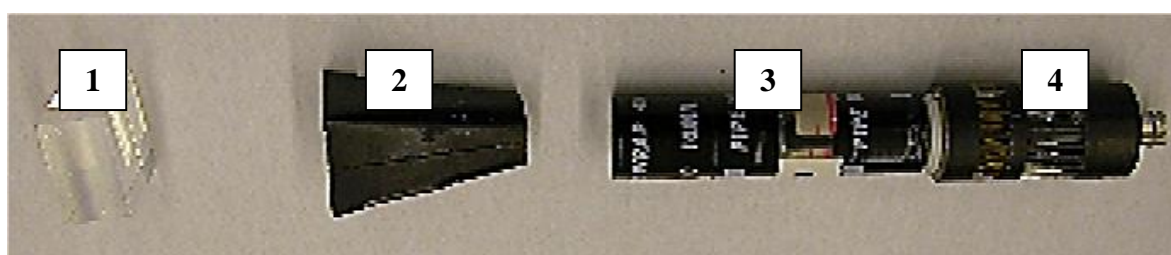
Рис. 8.3 – Функциональные элементы сцинтилляционной детекторной ячейки переднего годоскопа
