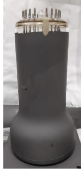
Рис. 8.35 – ФЭУ Hamamatsu R6091 (3-дюймовый фотокатод) с тонким каптон-медным защитным слоем.
