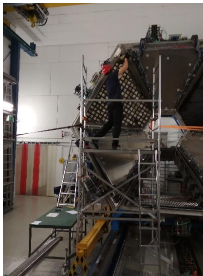
Рис. 8.36 – Заключительный этап монтажа сектора № 6 на платформу калориметра ECAL.
