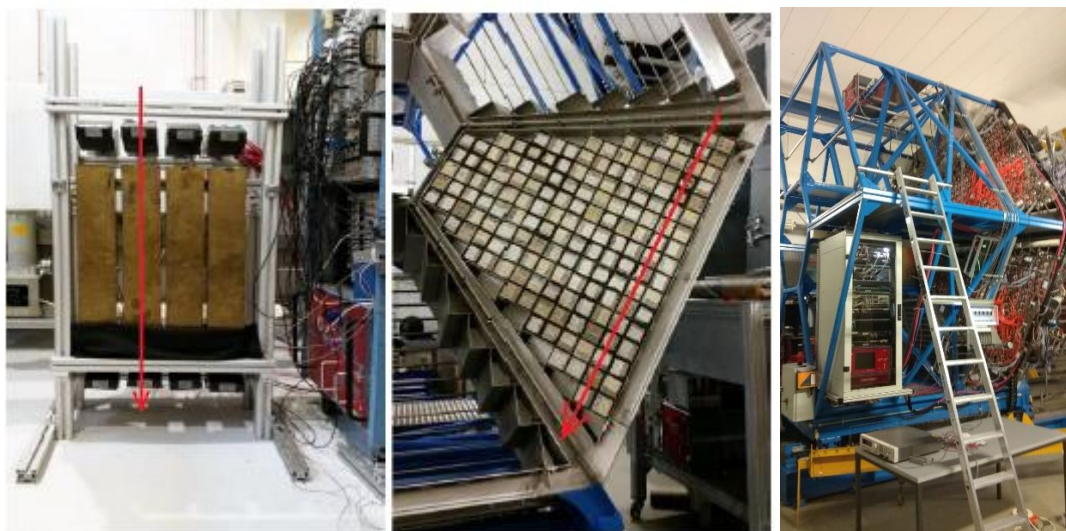
Рис. 8.31 – Слева– фотография 4-канального испытательного стенда для измерения ECAL-модулей на космических мюонах в детекторной лаборатории GSI; в центре – фотография со схемой испытаний на космических мюонах ECAL-модулей “in-situ” в секторных рядах, справа – собранный из 4 секций калориметр, готовый к физическому сеансу
