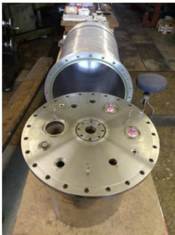
Рис. 13.15 – Элементы корпуса малой активной мишени АСТАФ2 (крышка с высоковольтными разъемами и цилиндрическая обечайка)
