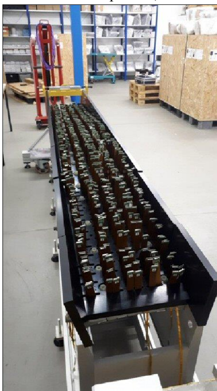
Рис. 14.10 – Макет балки из пластиковых листов закреплён на модулях с кристаллами
