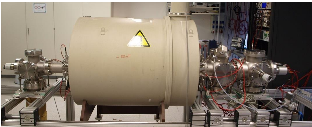
Рис. 13.20 – Подготовленный для эксперимента тор магнит с ионным трактом и детектором
