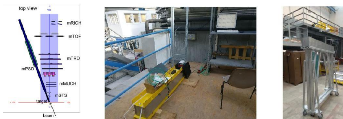
Рис. 12.27 – Схема размещения mPSD на установке mCBM, слева: в центре фото доставленного в GSI модуля PSD: справа – тестовые испытания в ИЯИ РАН установленного на изготовленной подставке модуля калориметра перед отправкой в GSI
