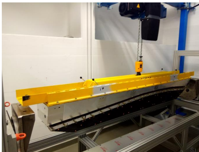
Рис. 14.6 - Перенос сектора в сборе с технологической балкой на поворотное устройство для тестов
