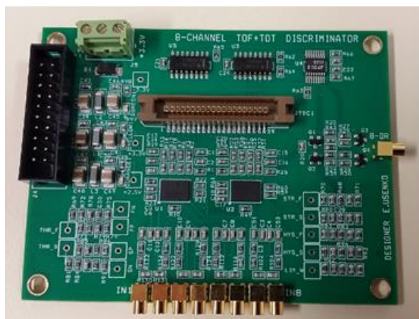
Рис. 8.24 – Слева модуль ToT преобразователя; справа, внешний вид платы TRB3 (многоканальная система регистрации временных отсчетов — Time Readout Board)
