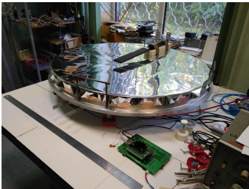
Рис. 19.9 – Тестирование прототипа станции трекера при атмосферном давлении рабочего газа
