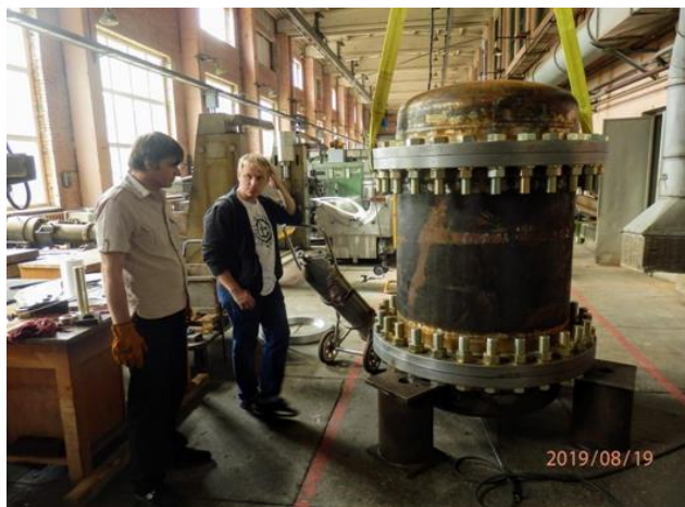
Рис. 19.4 Проведение критических испытаний корпуса детектора на давление
