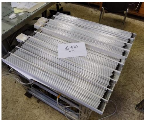
Рис. 13.10 – Дрейфовые трубки, изготовленные для станции X2
