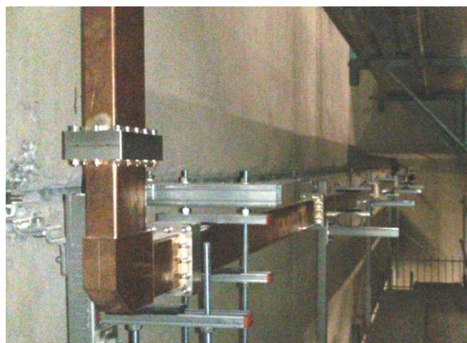
Рис. 2.2 – Структура поперечного отклонения пучка TDS INJ
