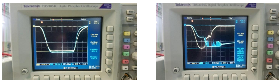
Рис. 2.8 – Осциллограммы напряжения (белый) и тока (голубой) клистрона: слева нормальная работа, справа – случай срабатывания быстрой блокировки
