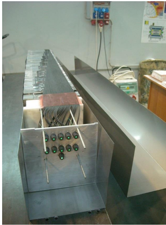
Рис. 14.20 – Фотография одного из собранных модулей (без верхней крышки) – на переднем плане видны оптические разъемы с вклеенными оптическими волокнами
