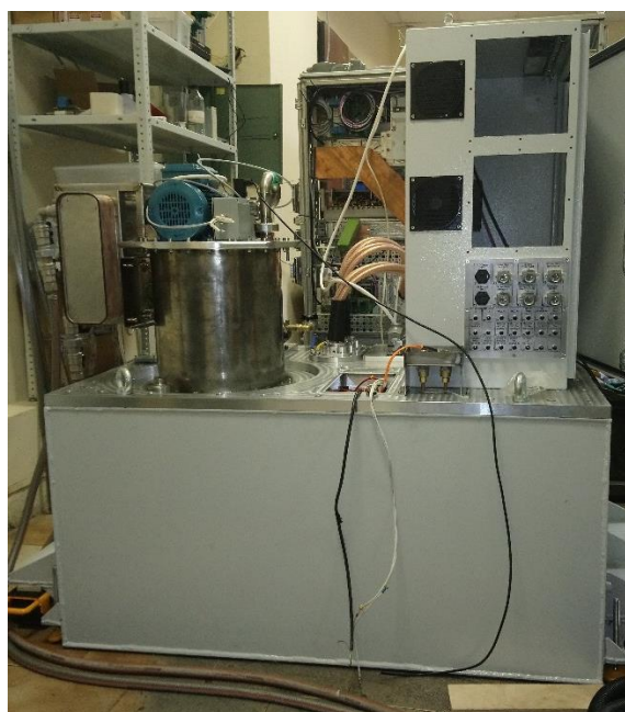
Рис. 2.3 – Импульсный трансформатор с установленной на нем эквивалентной нагрузкой (в процессе сборки слева и в собранном виде справа)
