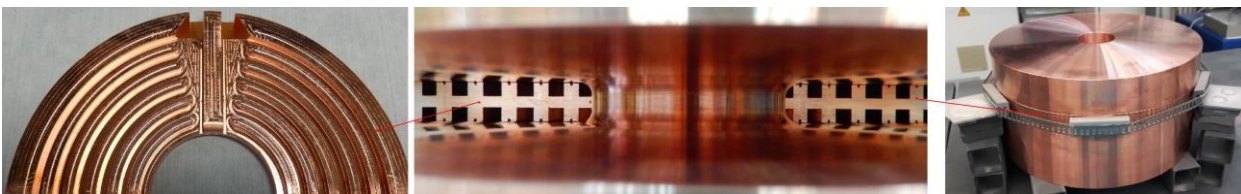
Рис. 3.1 – Полукольцо с каналами внутреннего распределения потоков, (слева), полукольцо в обработанном канале тестового элемента (в центре) и тестовый образец для пайки высокотемпературными припоями
