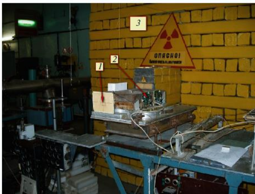
Рис. 16.5 – Вид поглотителя пучка бустера с мишенью из металлических блоков и облучаемых образцов
