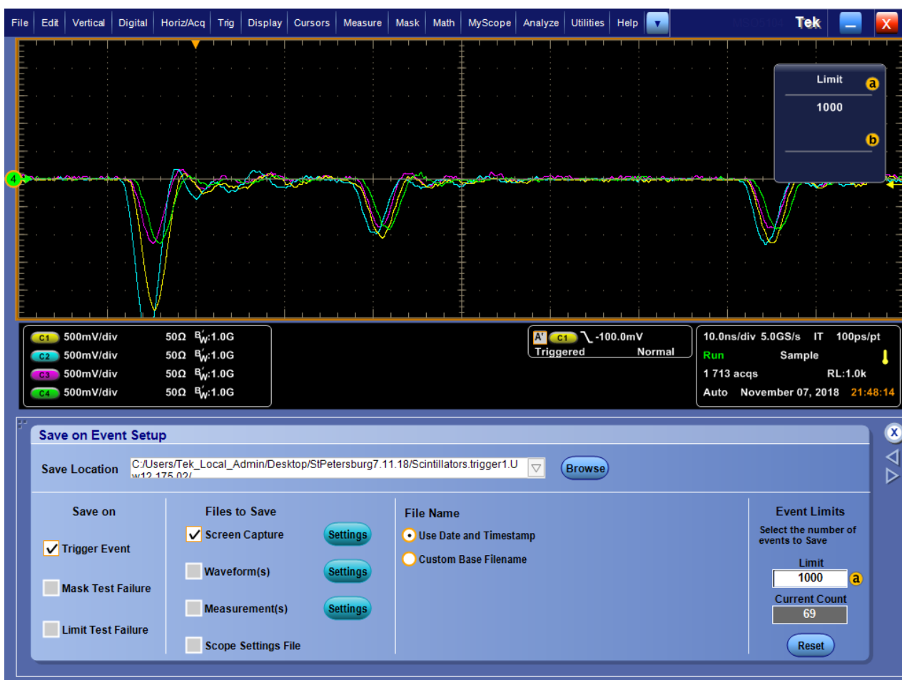
Рис. 21.4 – Сигналы 4-х фотоумножителей, записанные на осциллографе Tektronix MSO5204
