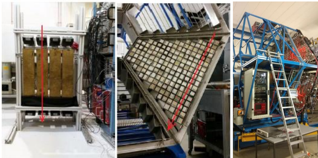
Рис. 10.12 – Слева– фотография 4-канального испытательного стенда для измерения ECAL-модулей на космических мюонах в детекторной лаборатории GSI; в центре – фотография со схемой испытаний на космических мюонах ECAL-модулей “in-situ” в секторных рядах, справа – собранный из 4 секций калориметр, готовый к физическому сеансу
