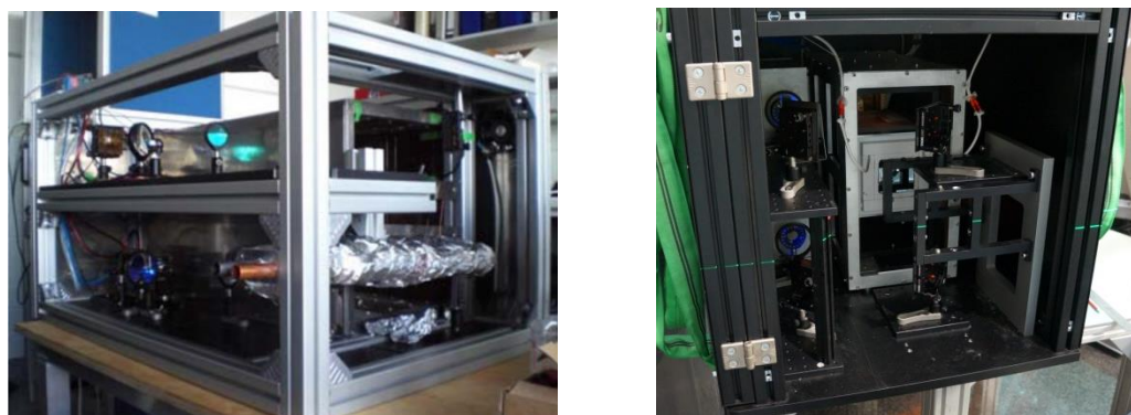
Рис. 19.2 – SEOP поляризатор; слева – общий вид, справа – установка SEOP поляризатора на пучок
