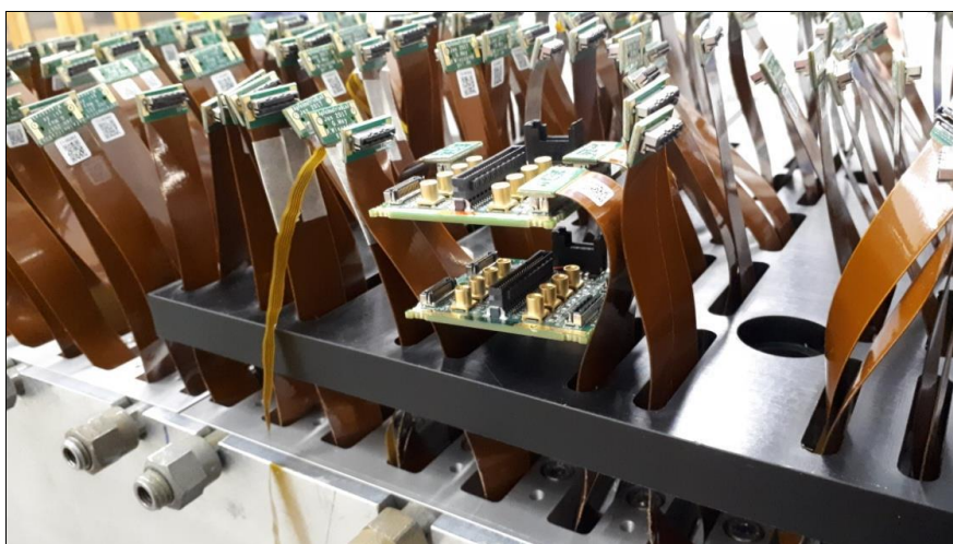
Рис. 16.15 – Фрагмент макета днища несущей балки сектора с коммутационной платой
