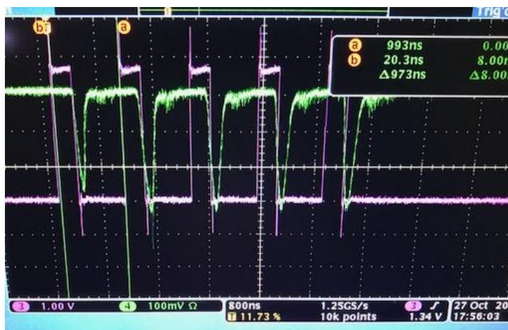
Рис. 16.37 - Пример сигнала подсветки (зеленый), полученного с помощью ФЭУ, при генерации 5-и последовательных импульсов (розовый) длительностью 300 нс каждый
