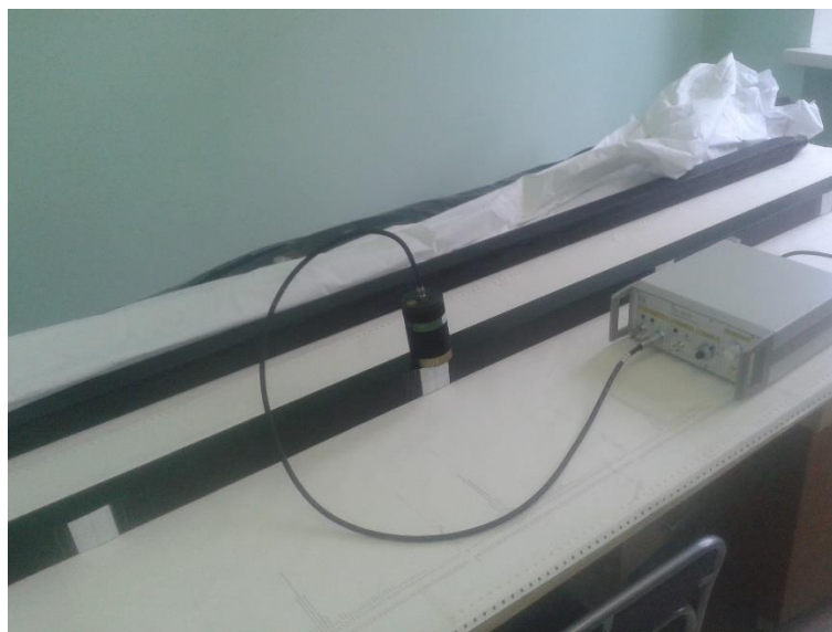
Рис. 15.3 – Тестирование сцинтиляционных полос и фотоумножителей с помощью UV лазера в ПИЯФ
