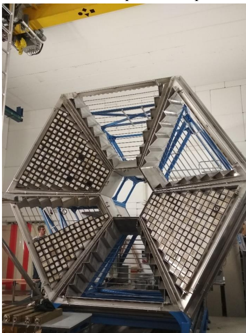
Рис. 10.13 - Статус сборки ECAL на установке ХАДЕС (состояние на начало декабря 2017 г)
