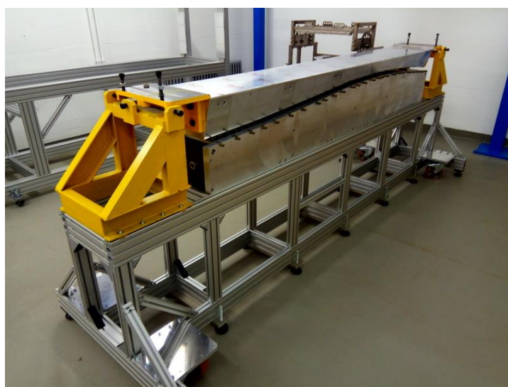
Рис. 16.28 – Изготовленные в НИЦ КИ-ИФВЭ прецизионная несущая балка со сборочным и монтажным приспособлением
