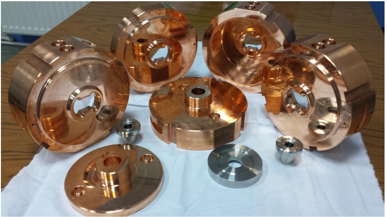
Рис. 3.1 – Ячейки резонатора ВЧ дефлектора с минимизированным уровнем собственных aberrаций
