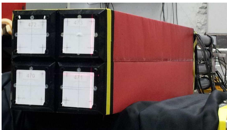
Рис. 19.13. Прототип калориметра типа «шашлык» из четырех модулей (16 ячеек).
