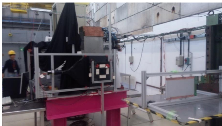
Рис. 8.3 Вид на прототип адронного калориметра со стороны пучка. В правой части виден прототип электромагнитного калориметра.
