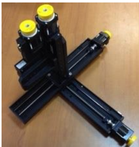
Рис. 15.2 Прототип мишенного манипулятора. Слева сборка из трех линейных актуаторов и одного вращательного манипулятора. Справа – блок контроллеров манипулятора.
