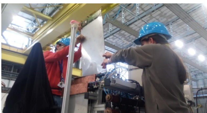
Рис. 8.4 Установка одной из базовых плат адронного калориметра в прототип.
