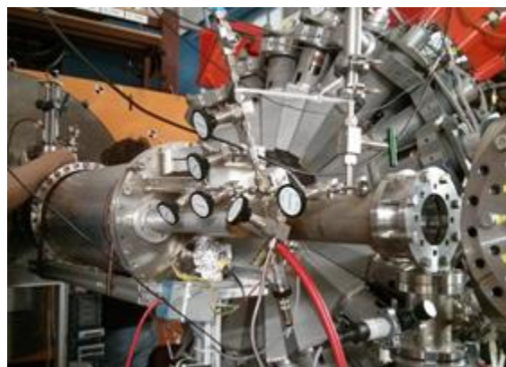
Рис. 9.5 Прототип детектора для изучения упругого рассеяния протонов на тяжелых ядрах на пучке ускорителя в GSI.
