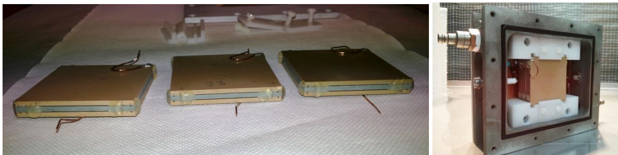
Рис. 17.3 Три отдельные двухзазорные керамические камеры и шестизазорная камера, установленная в газовый бокс для испытаний
