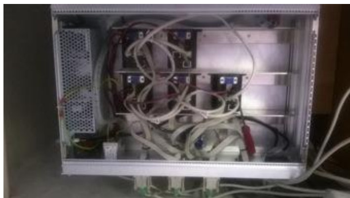
Рис. 15.2 Прототип мишенного манипулятора. Слева сборка из трех линейных актуаторов и одного вращательного манипулятора. Справа – блок контроллеров манипулятора.
