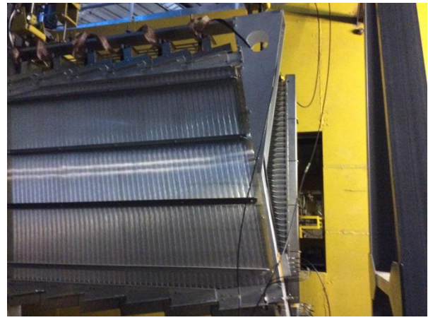
Рис. 3.25 Четвертая станция камер на рабочем месте с установленным перед ней триггерным счетчиком на взаимодействие; справа — третья станция, расположенная сразу после магнита.
