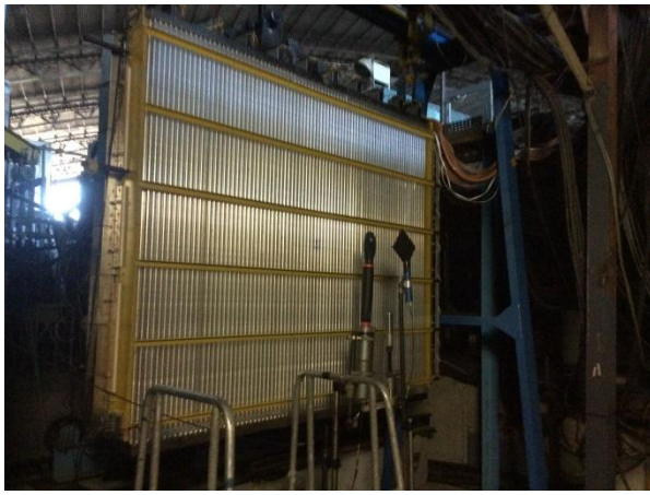
Рис. 3.25 Четвертая станция камер на рабочем месте с установленным перед ней триггерным счетчиком на взаимодействие; справа — третья станция, расположенная сразу после магнита.
