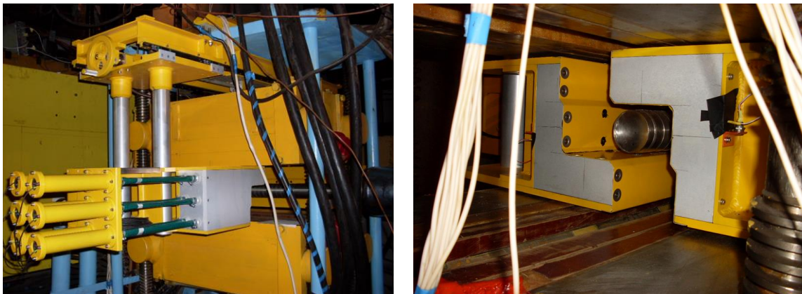
Рис. 3.8 Фотография вето-системы вокруг поляризованной протонной мишени
