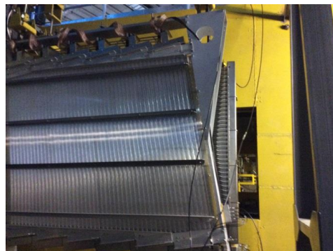
Рис. 3.29 Четвертая станция камер на рабочем месте с установленным перед ней триггерным счетчиком на взаимодействии; справа — третья станция, расположенная сразу после магнита.
