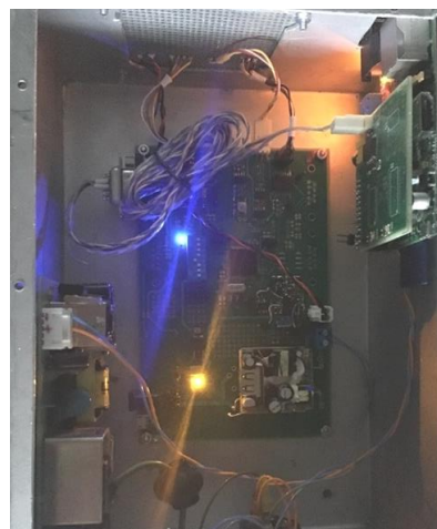
Рис. 3.50 Модуль мониторинга параметров магнита мишени «Динозавр»
