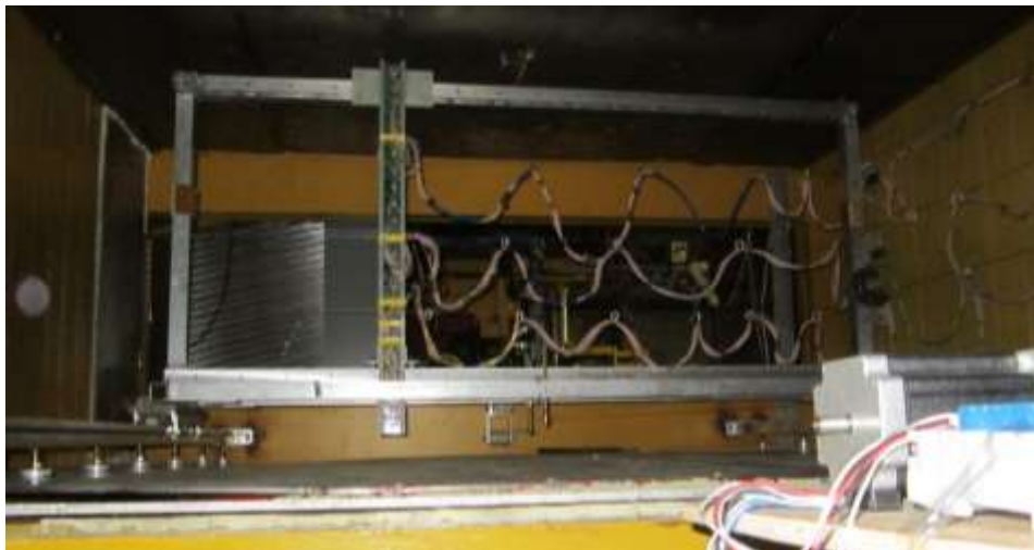
Рис. 3.25 Система измерения магнитного поля, смонтированная на спектрометрическом магните
