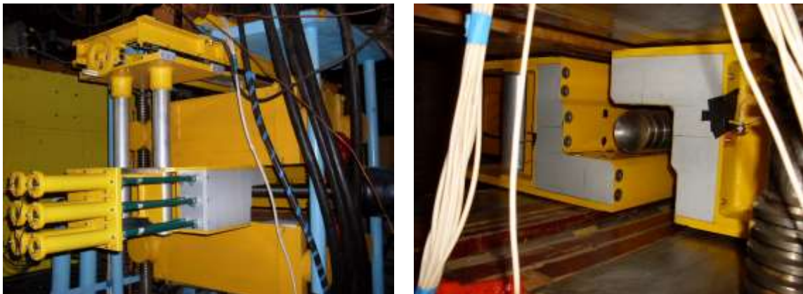
Рис. 3.8 Фотография вето-системы вокруг поляризованной протонной мишени
