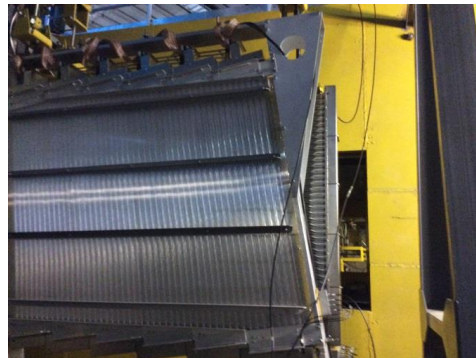
Рис. 3.29 Четвертая станция камер на рабочем месте с установленным перед ней триггерным счетчиком на взаимодействие; справа — третья станция, расположенная сразу после магнита.
