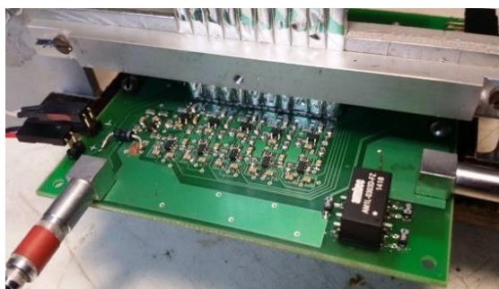
Рис. 2.16 Электронная плата с фотодетекторами, усилителями, дискриминаторами и LVDS-передатчиками
