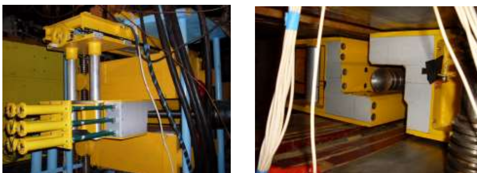
Рис. 3.8 Фотография вето-системы вокруг поляризованной протонной мишени
