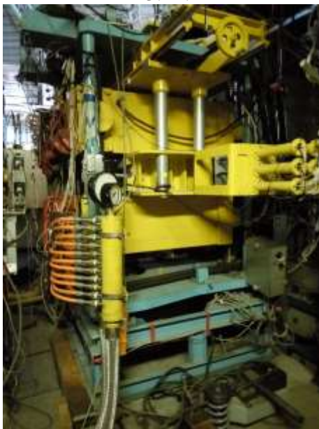
Рис. 3.11 Общий вид магнита ДИНОЗАВР — 2.4 Т с введённой в рабочее положение охранной системой и рабочими коммуникациями на установке СПАСЧАРМ на канале 14 ускорителя У-70
