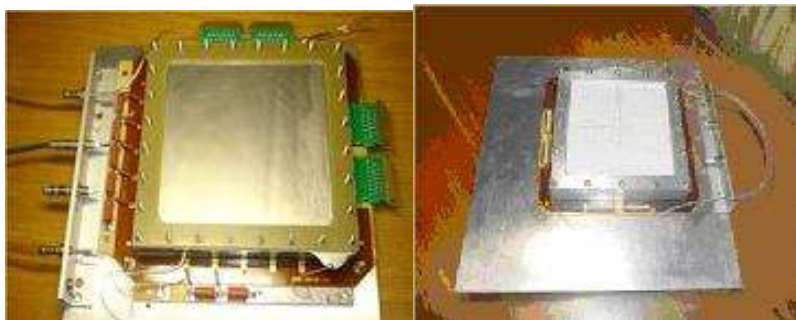
Рис. 3.27 Фотографии двух прототипов GEM детекторов
