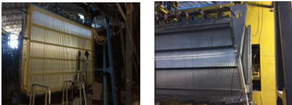
Рис. 3.29 Четвертая станция камер на рабочем месте с установленным перед ней триггерным счетчиком на взаимодействие; справа — третья станция, расположенная сразу после магнита.
