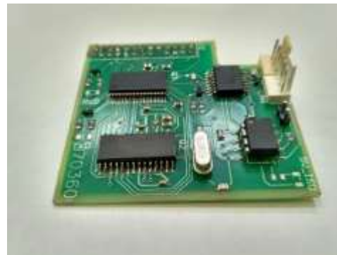
Рис. 3.48 Адаптер шин для Modbus RTU и CAN
