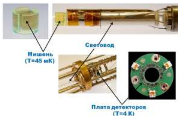
Рис. 3.18 Основные внутренние узлы созданной совместными усилиями (Майнц-Бонн-Бохум-ОИЯИ) мишени-сцинтиллятора
