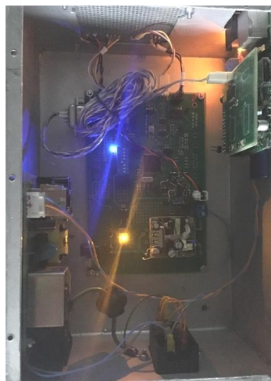
Рис. 3.50 Модуль мониторинга параметров магнита мишени «Динозавр»
