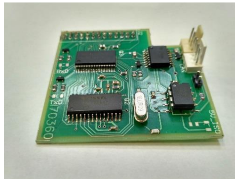
Рис. 3.48 Адаптер шин для Modbus RTU и CAN
