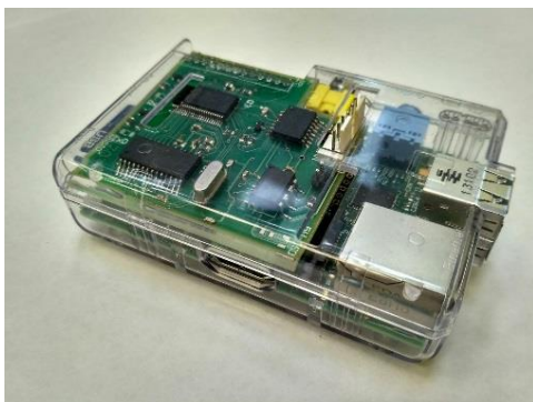
Рис. 3.48 Адаптер шин для Modbus RTU и CAN
