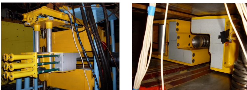
Рис. 54 Фотография вето-системы вокруг поляризованной протонной мишени
