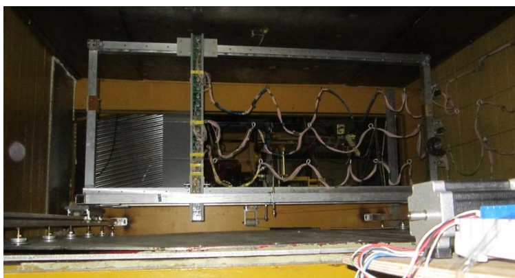
Рис. 3.21 Система измерения магнитного поля, смонтированная на спектрометрическом магните
