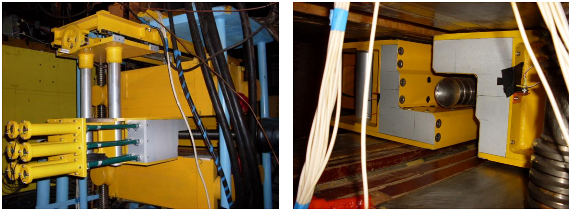
Рис. 3.8 Фотография вето-системы вокруг поляризованной протонной мишени
