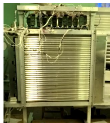
Рис. 3.23 Схема расположения трубок (левая панель) и фото камеры DT1 перед установкой на штатное место (правая панель)
