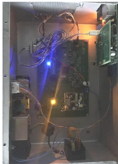
Рис. 3.46 Модуль мониторинга параметров магнита мишени «Динозавр»
