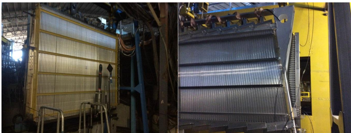
Рис. 3.14 Четвертая станция камер на рабочем месте с установленным перед ней триггерным счетчиком на взаимодействие, справа – третья станция, расположенная сразу после магнита.
