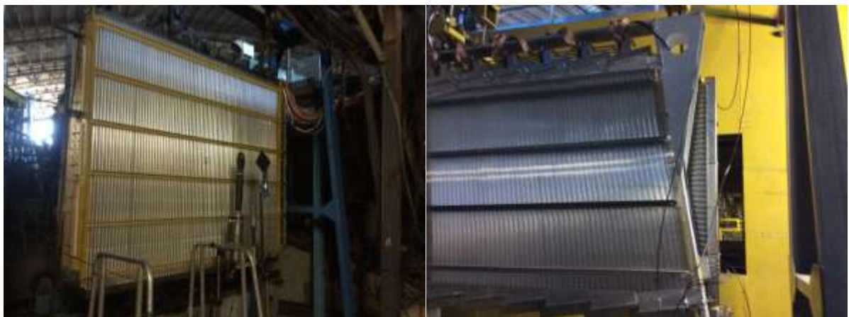
Рис. 3.24 Четвертая станция камер на рабочем месте с установленным перед ней триггерным счетчиком на взаимодействие, справа – третья станция, расположенная сразу после магнита.
