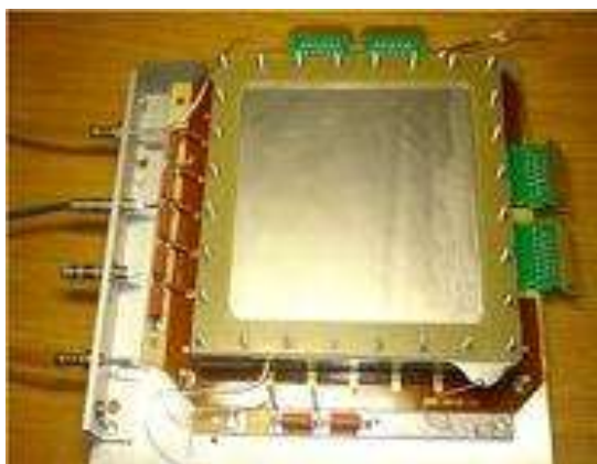
Рис. 3.21 Фотографии двух прототипов GEM детекторов для установки СПАСЧАРМ.
