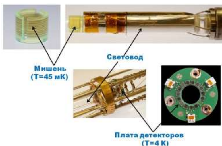
Рис. 3.13 Основные внутренние узлы, созданной совместными усилиями (Майнц-Бонн-Бохум-ОИЯИ) мишени-сцинтиллятора
