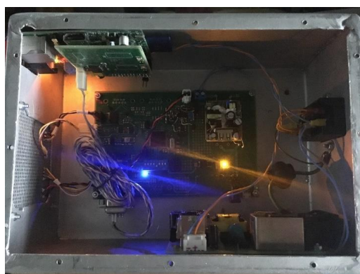
Рис. 3.45 Модуль мониторинга параметров магнита мишени «Динозавр»
