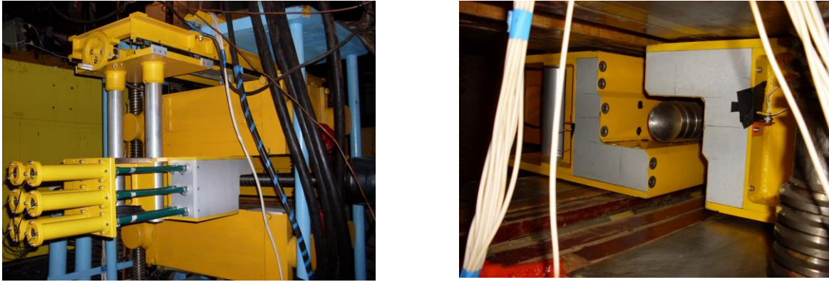
Рис. 3.8 Фотография вето-системы вокруг поляризованной протонной мишени
