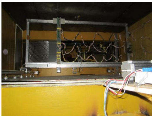
Рис. 3.20 Система измерения магнитного поля, смонтированная на спектрометрическом магните
