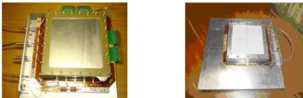
Рис. 3.12 Фотографии двух прототипов GEM детекторов для установки СПАСЧАРМ.
