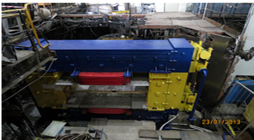
Рис. 3.8 – Фотография спектрометрического магнита М31 на канале 14
