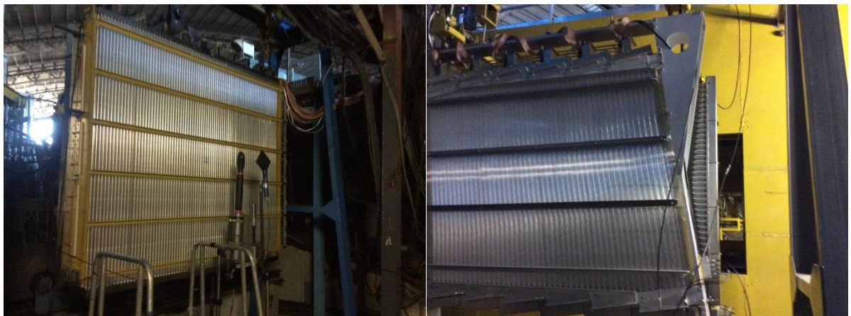
Рис. 3.15 Четвертая станция камер на рабочем месте с установленным перед ней триггерным счетчиком на взаимодействие, справа – третья станция, расположенная сразу после магнита.
