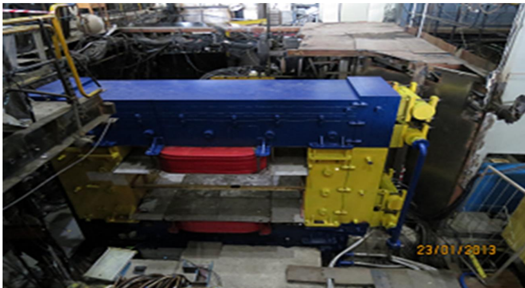
Рис. 3.16 – Фотография спектрометрического магнита М31 на канале 14
