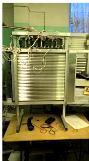
Рис. 3.22 Схема расположения трубок (левая панель) и фото камеры перед установкой на штатное место (правая панель)
