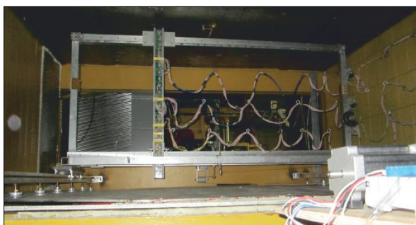
Рис. 71. Система измерения магнитного поля, смонтированная на спектрометрическом магните
